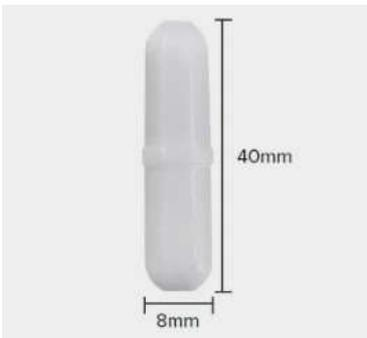
Магнитный мешальник 8x40 мм для магнитной мешалки
