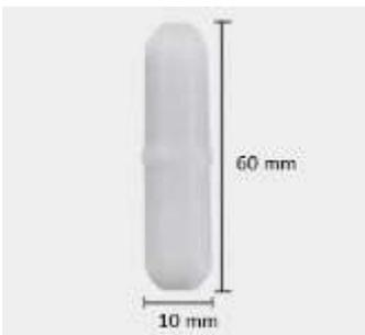
Магнитный мешальник 10x60 мм для магнитной мешалки
