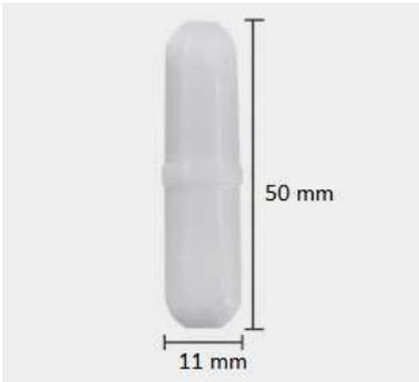
Магнитный мешальник 11x50 мм для магнитной мешалки
